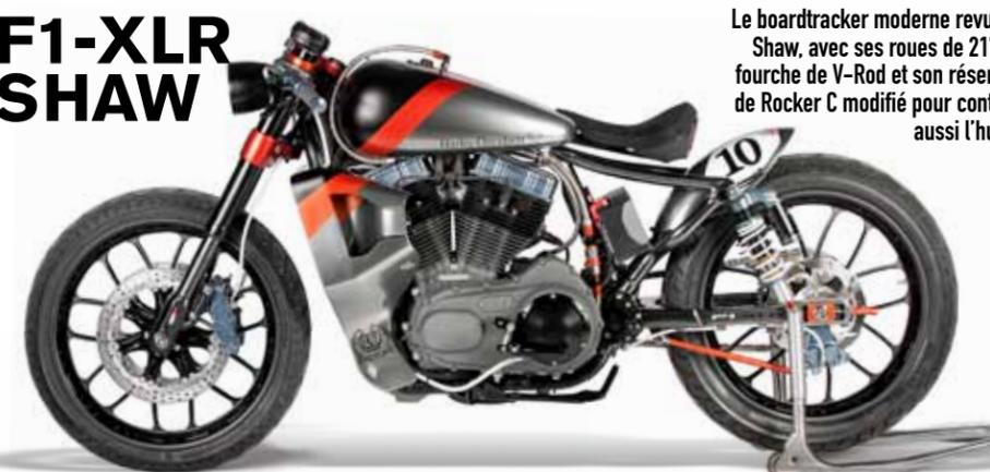
Le boardtracker moderne revu par Shaw, avec ses roues de 21", sa fourche de V-Rod et son réservoir de Rocker C modifié pour contenir aussi l'huile!
